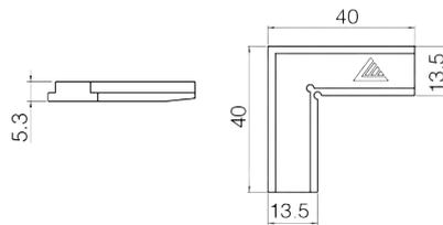
**JUNTA PARA TOPE DE PUERTA EN BASTIDOR**
